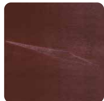
Прогар от дефекта наружного слоя (повреждение фанеры)
