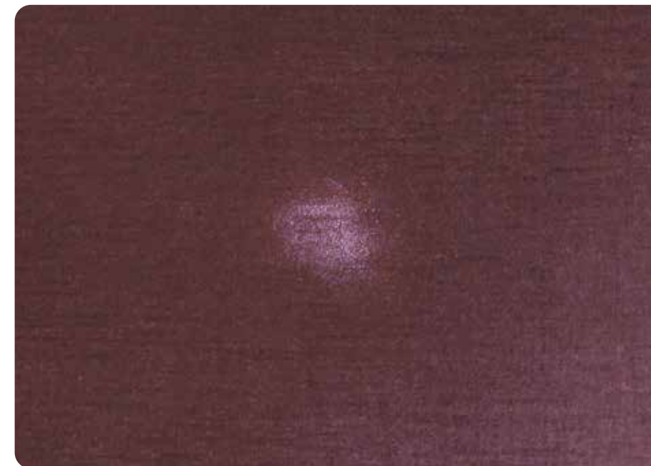
Прогар от дефекта внутреннего слоя (отверстие от выпавшего сучка)
