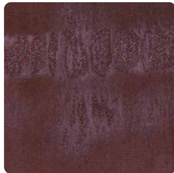
Прогар от дефекта наружного слоя (полоса от шлифования)
