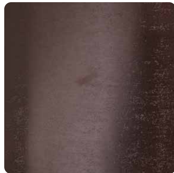
Прогар от дефекта наружного слоя (пятно от шлифования)
